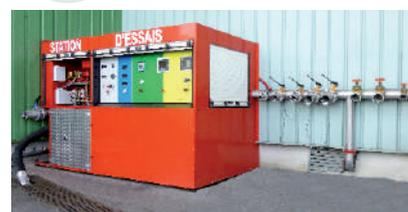
CTD testet alle Systeme seines Sortiments mit einer modernen Kontrolleinheit, bestehend aus Pumpe, Messsensor und Elektronik.
