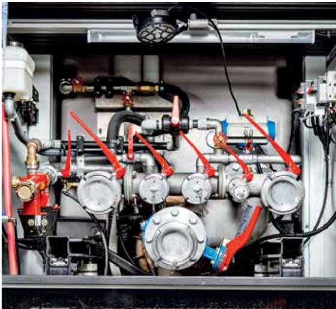
/ Die Ausführung des Pumpenbedienstands im Fahrzeugheck erfolgt gemäß Ihren individuellen Erfordernissen und Vorgaben. Die Grundausführung verfügt über eine bewusst einfache analoge Steuerung.
