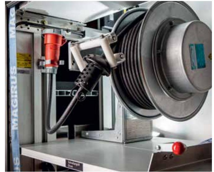
/ Der Schnellangriff Strom ermöglicht die schnellere Inbetriebnahme z.B. von Beleuchtungseinheiten oder hydraulischem Gerät.
