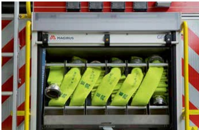
Einsatztaktisch optimal: Schlauchverlege-Einrichtung am Heck
