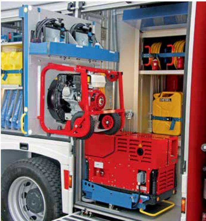
/ Optimale Nutzung des Raumes auch in die Tiefe: Der Geräteraum ist zwischen den Achsen tiefgezogen und bietet eine dritte Ebene zur Lagerung von Sekundärmaterial.
