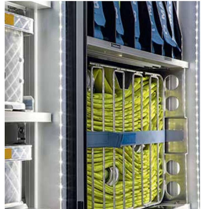
/ LED-Lichtbänder leuchten die Geräteraume blendfrei aus und gewährleisten sicheres Arbeiten bei Tag und Nacht.
