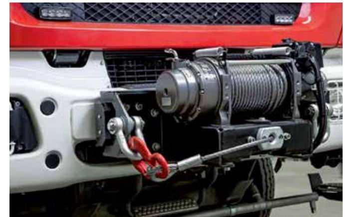
/ Frontseilwinde für Technische Hilfeleistung und Selbstbergung
