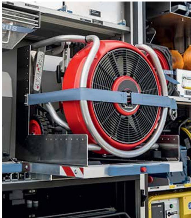
Herausziehbare Schwerlastauszüge gewährleisten die optimale Lagerung und kräfteschonende Entnahme mobiler Geräteeinheiten wie z. B. Lüfter oder hydraulisches Rettungsgerät.
