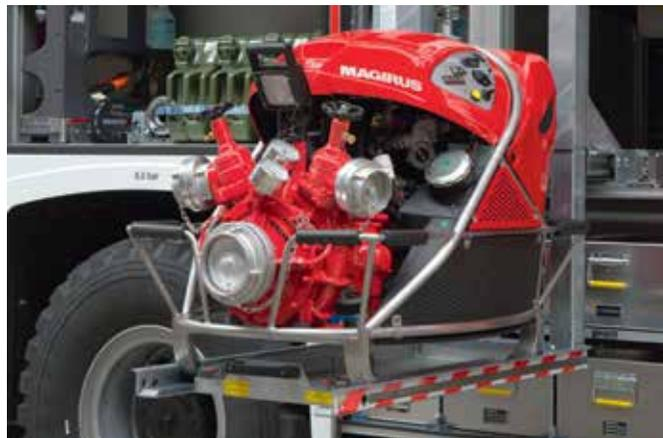
Absenkbare Tragkraftspritzen-Lagerung für ergonomische Entnahme
