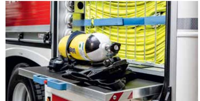
Die praktische herausziehbare Arbeitsplatte kann genutzt werden, um Ausrüstungsgegenstände und Geräte in ergonomisch günstiger Höhe abzulegen – z. B. beim Wechseln von Atemschutzflaschen an der Einsatzstelle.
