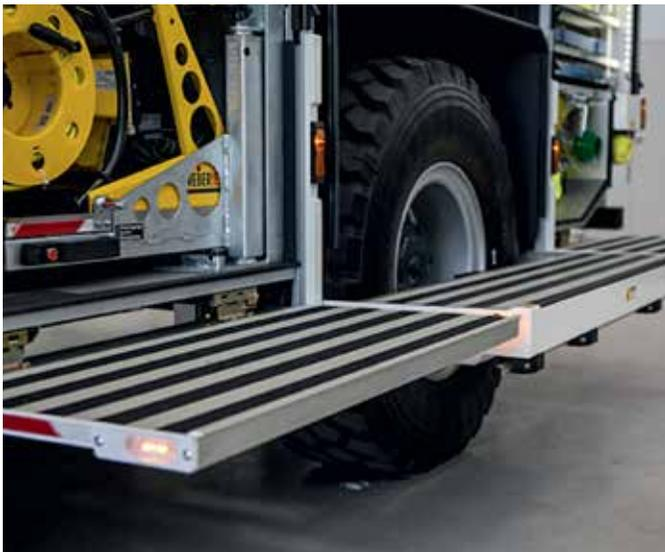
Die Klappen am Aufbau sind rutschsicher und stabil bis 250 kg. Auch bei Fahrzeugen mit großer Bereifung ist eine sichere Geräteentnahme möglich.
