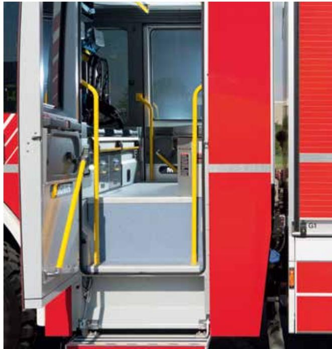
Die Tür der Aluminium-Kabine kann um 90° geöffnet werden. Der Auftritt klappt dabei in ergonomisch günstiger Höhe automatisch aus. Voll ausgeleuchtete, rutschfeste Trittplächen und farblich abgesetzte Haltegriffe gewährleisten maximale Sicherheit beim Ein- und Ausstieg. Geeignet für Euro 6-Abgastechnologie.
