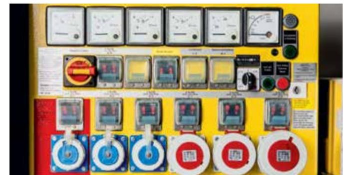
Als Alternative liefern wir Stromgeneratoren, die über einen Nebenantrieb vom Fahrgestell versorgt werden. Das Bedienfeld ermöglicht ergonomisches und sicheres Arbeiten.
