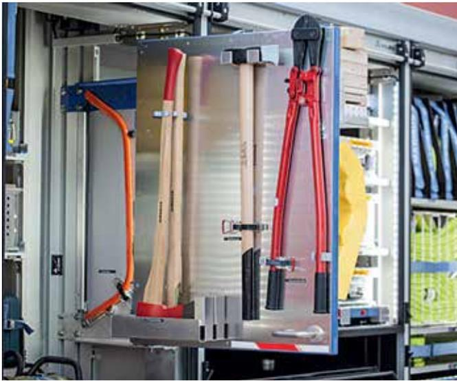
/ Die beidseitig zugängliche Drehwand ist leichtgängig und kann sicher verriegelt werden.
