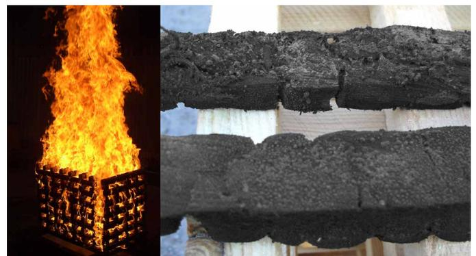
1.) Zu Brandschutztests eingesetzter, brennender Holzstapel 2.) Verkokte Holzstäbe mit deutlich sichtbaren Schmelzrückständen des Löschpulvers auf der Oberfläche
