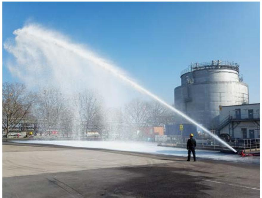
Das vorhandene Equipment der BASF Werkfeuerwehr ist weitgehend mit den neuen Schaummitteln kompatibel – so auch der hier eingesetzte Wasserwerfer bei einem Versuch auf dem Übungsplatz der Werkfeuerwehr.
