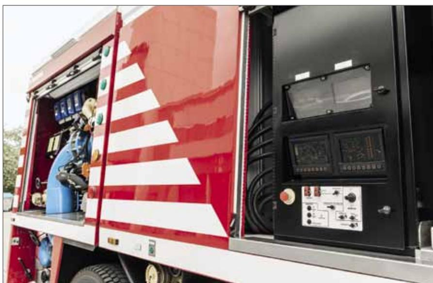
Pumpenbedienstand mit Kamera für das Heck und die Fahrzeugseite links.
