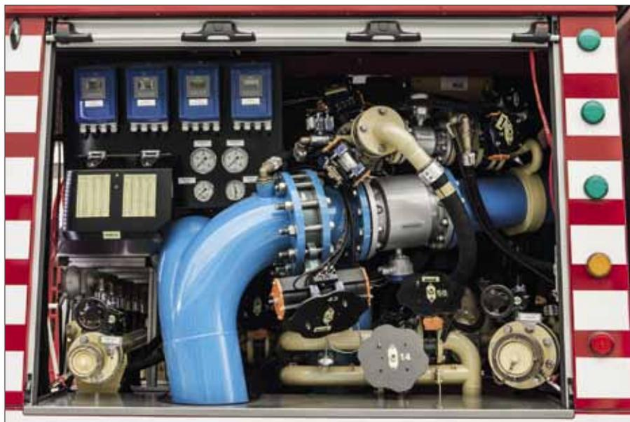
Monitorleitung und Notbedienstand sowie Saug- und Druckseite für Schaummittelpumpe 2.
