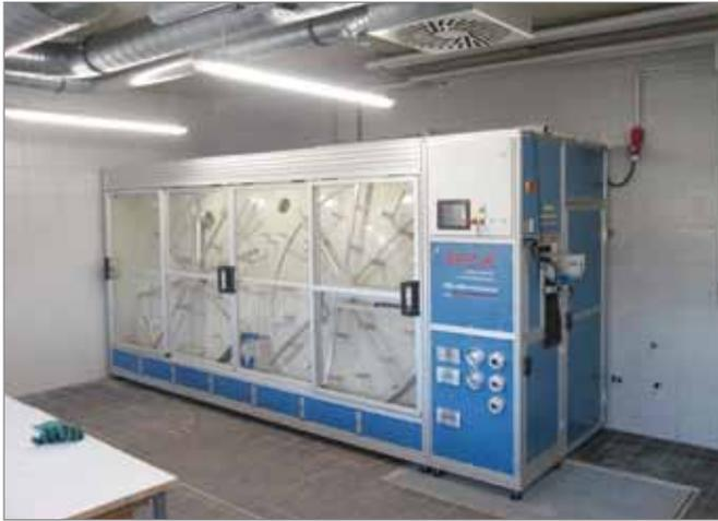
Das Schlauchpflegezentrum Kompakt (SPZ-K) ist eine vollautomatische Anlage zum Vorweichen, Waschen, Druckprüfen, Trocknen und Wickeln von bis zu 15 Schläuchen je Stunde durch eine Person.
