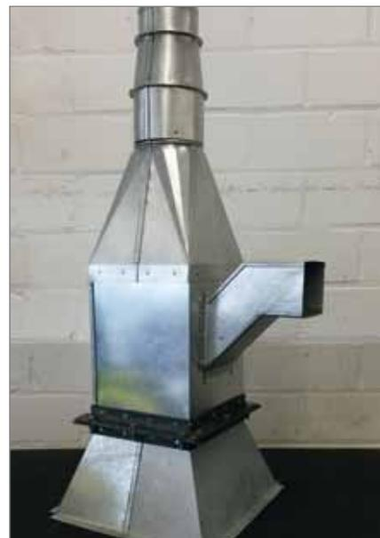
Arbeitsprobe praktische Prüfung, Teil 1: Prüfungswerkstück Metall nach der Zwischenprüfung nach den 18 Monaten handwerklicher Ausbildung.
