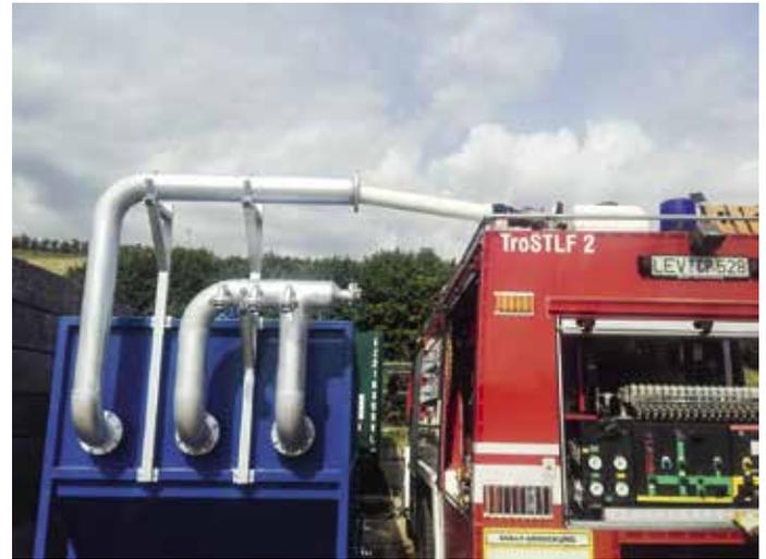
Abb. 11: Spülung eines Schaumwerfers mit PerfluorAd-angereichertem Spülwasser.
