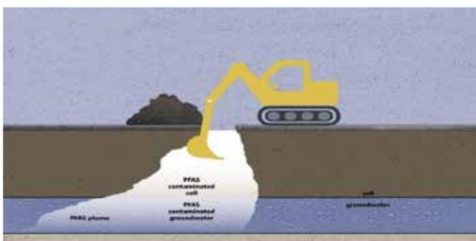
Abb. 2: Skizzenhafte Darstellung eines Bodenaushubs nach erfolgtem Versickern von Löschwasser in den Untergrund.
