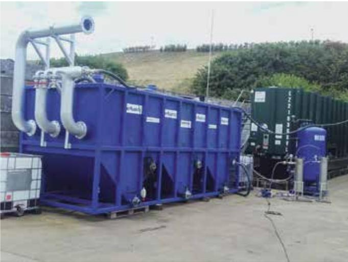
Abb. 10: Mobile PerfluorAd-Anlage zur Unterstützung bei der Reinigung von Einsatzfahrzeugen (der kleine blaue Behälter am rechten Bildrand stellt den für den Reinigungsprozess erforderlichen Aktivkohlefilter dar, der durch die PerfluorAd-Reinigung sehr klein dimensioniert werden kann).
