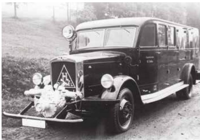
Abb. 3: Kraftspritze der Marke Flader auf Hansa-Lloyd Fahrgestell
